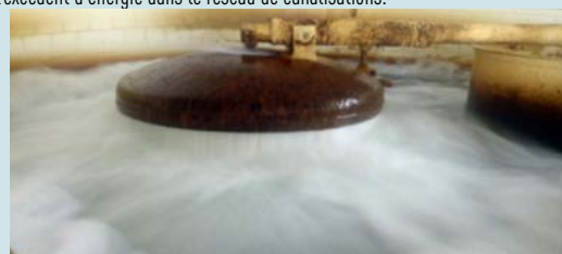
Figure 176 - Dissipation de la pression hydraulique à l'aide d'une soupape de sécurité
